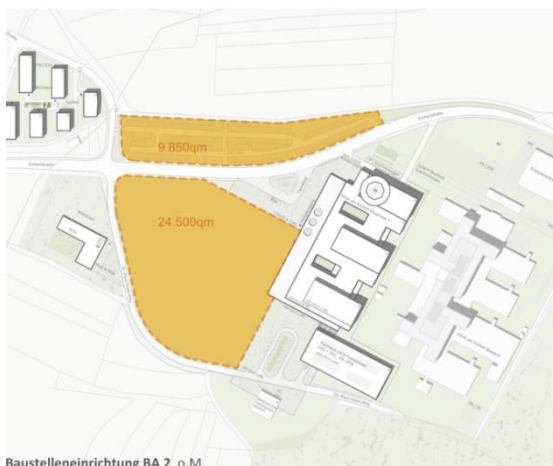
Baustelleneinrichtung BA 2 o.M.
